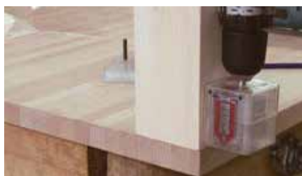
5. Utilizar o MINIMAG para finalizar a fixação
