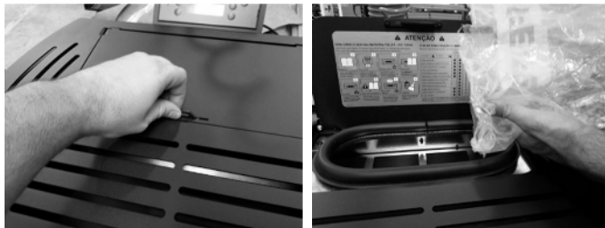
Figura 135 – Abastecimento do depósito de pellets
