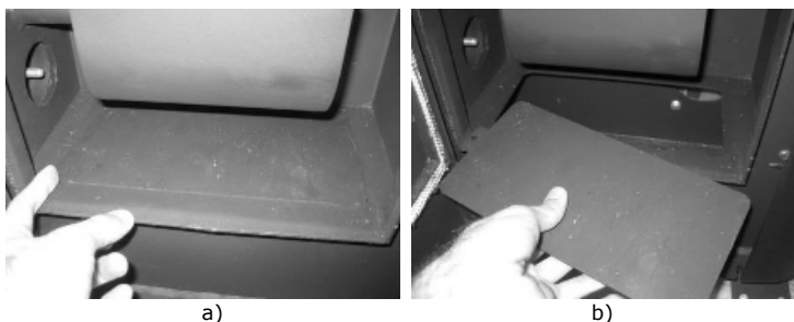
Figura 140 – Limpeza do interior da salamandra
